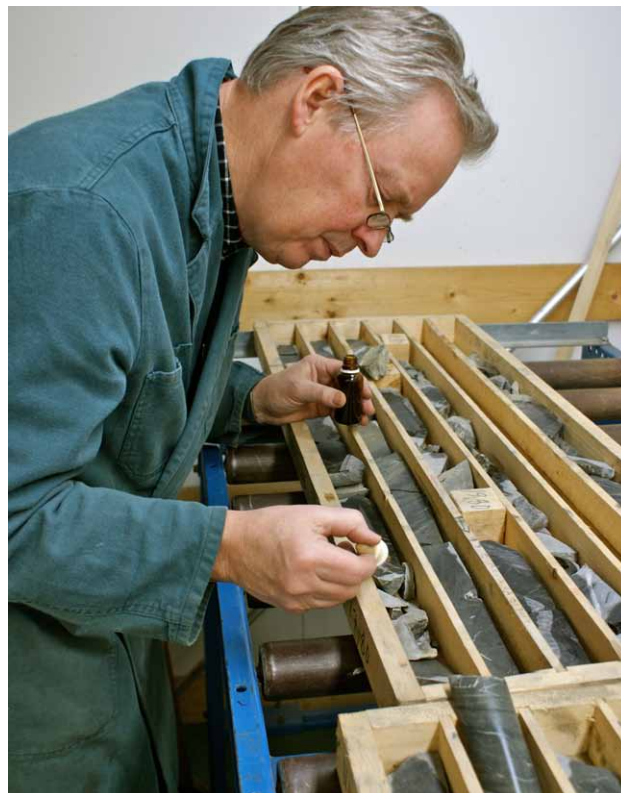
Kontroll av karbonatinnehåll i borrhkärna med saltsyra.
