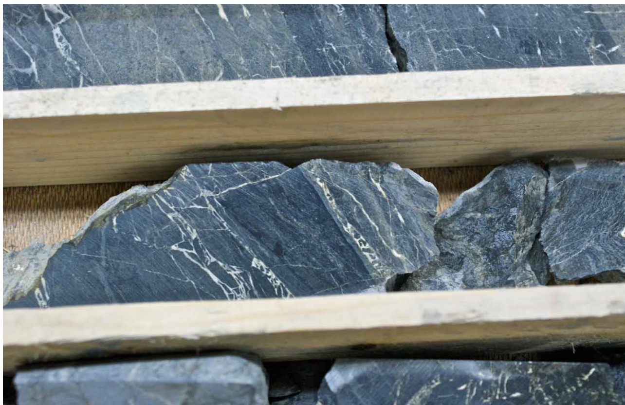
Sågad borrhöjnings kärna med tektoniska zoner.
