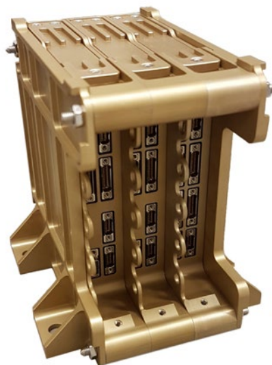
Datahanteringssystem, som består av omborddator (Sirius OBC) och ett massminne (Sirius TCM).
