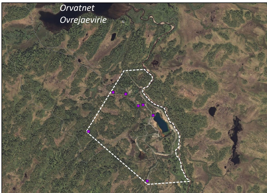
Figur 4 Figuren viser planområdet med hvit stiplet linje og de 7 eksisterende luftesjaktene med lilla firkanter
